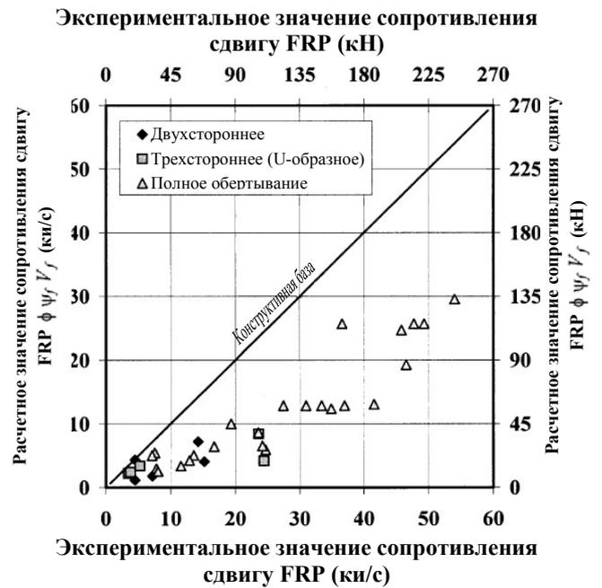
Рис. 10.3 – Сравнение экспериментальных результатов с результатами, полученными при использовании рассматриваемой методики проектирования.
