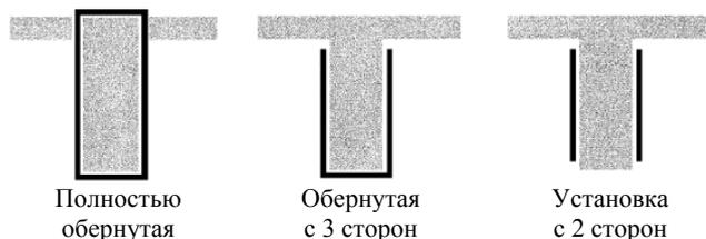
Рис. 10.1 – Типичные схемы обертывания для увеличения предела прочности на сдвиг с помощью ламинатов FRP.
